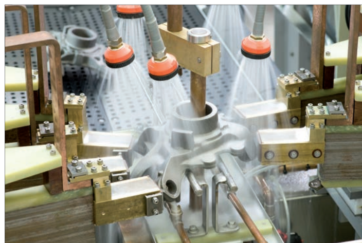
DEUTROMAT 實績：5 接點搭配穿棒，位置均可任意調整
