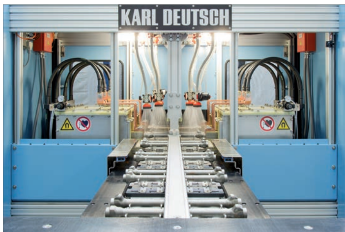
DEUTROMAT 實績：搭載鏈式輸送帶，一次檢測 8 個工件
