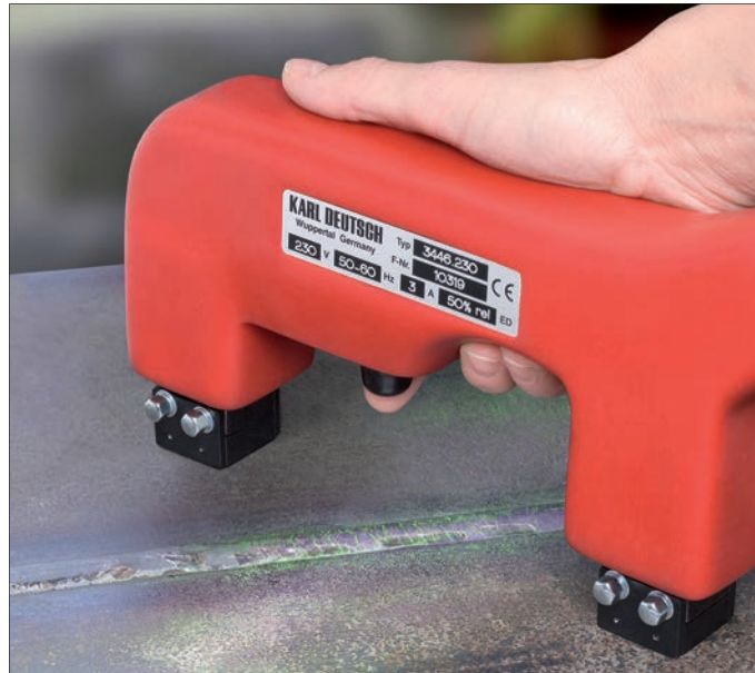
以手持式磁軛檢測焊縫品質 (DEUTROPULS 3446)
