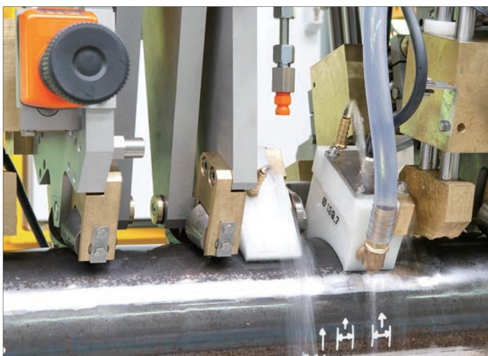
高頻電阻焊管（ERW）的超音波相控陣自動化檢測系統
