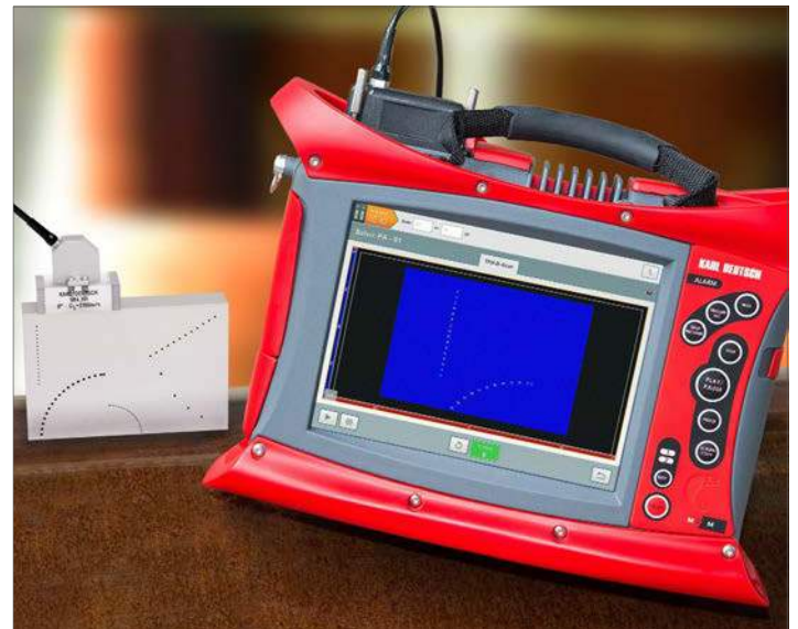
可攜式相控陣探傷主機、相控陣探頭和焊縫規塊
