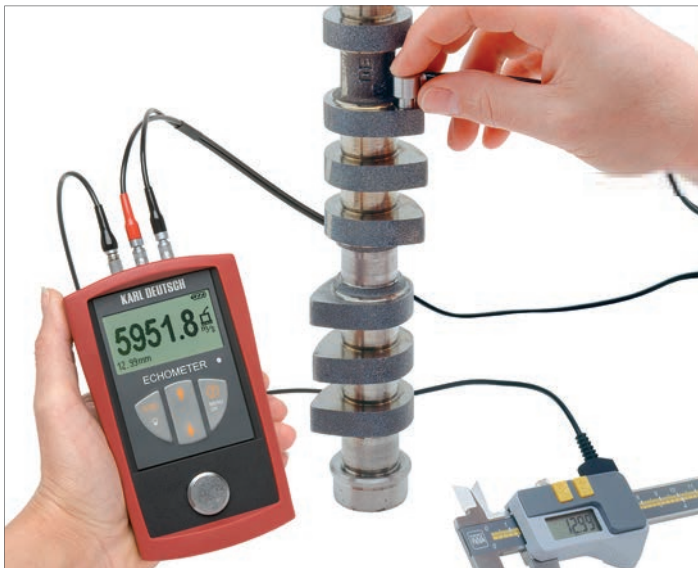
ECHOMETER 1076：凸輪軸上進行聲速測量
