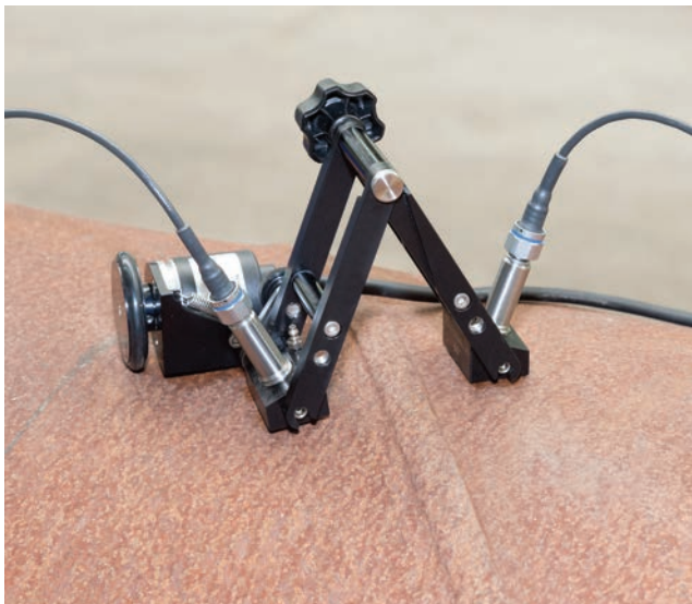
對接焊縫及環狀焊縫的手動掃查。配置編碼器、2個TOFD探頭及探頭支架
