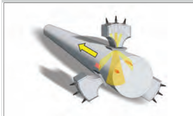
3個探頭架共9個探頭檢測圓棒材的圖示
